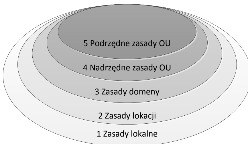
Rys.2.3.2 Kolejność przetwarzania zasad GPO.
